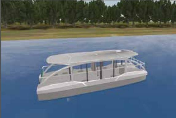
**Comment rendre autonome un bateau qui n'est pas encore à disposition ? En créant un environnement de simulation pour tester, itérer et manipuler le jumeau numérique d'un bateau de 12t.**
